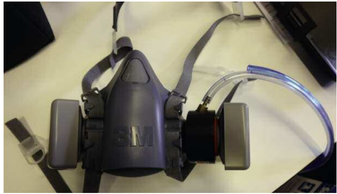
Maske G med adapter montert på høyre side, slangen fra portacounten er montert på adapteret. Den blå slangen måler partikler i lufta utenfor maska og den blanke måler partikler i lufta inni maska. Foto Solveig Føreland
