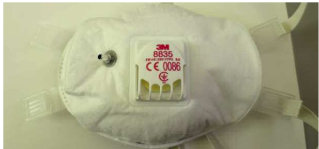
FF maske med nippel montert som slangen fra Portacounten monteres på for å kunne måle partikler inni maska. Foto Solveig Føreland
