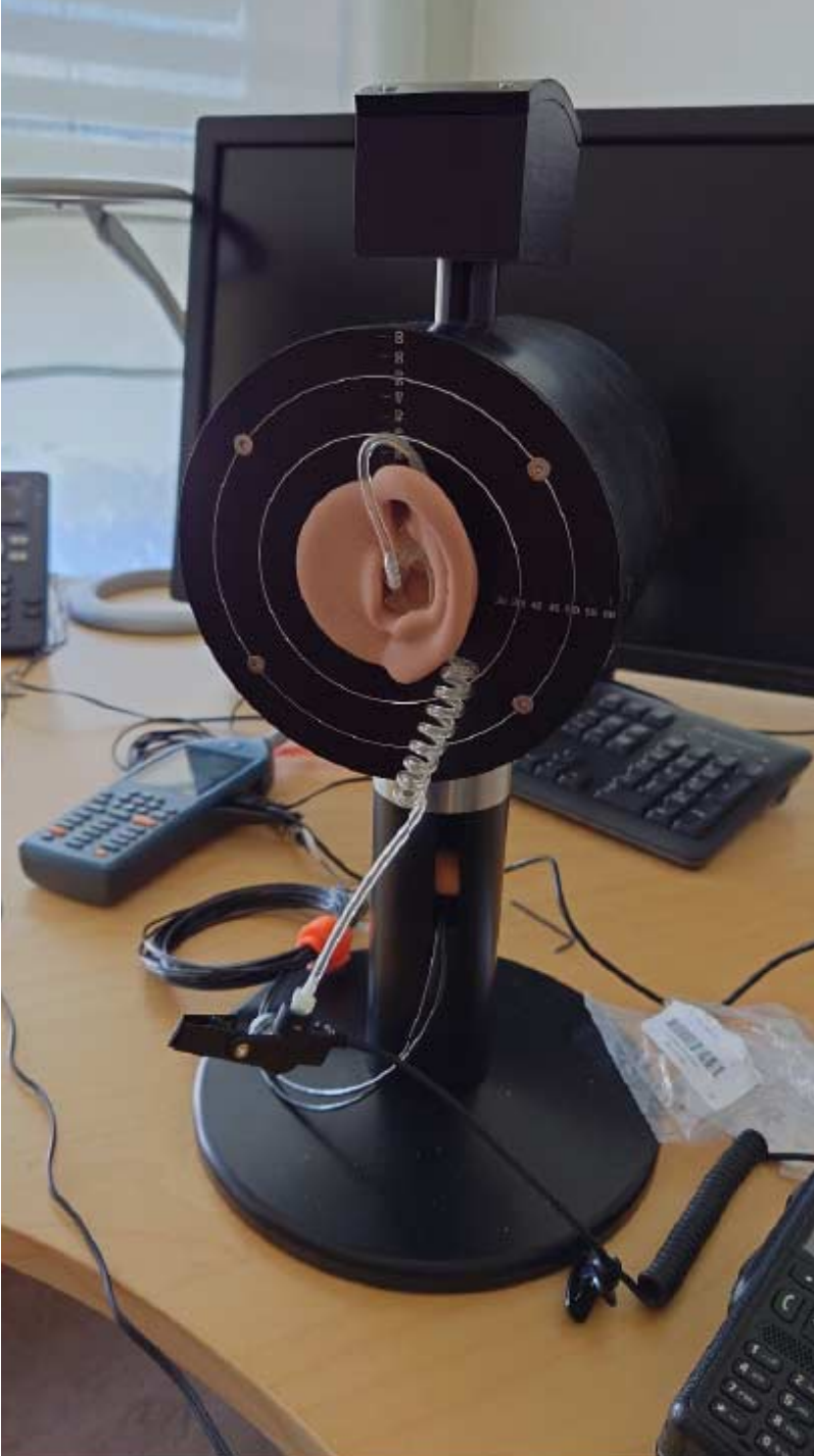
Figur 1: Testoppsett med kunstig øre for måling av støy fra samband, her med innstiks øretelefon.
