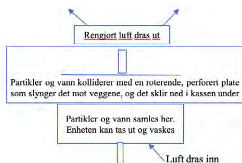
Figur 1: Figuren viser et skjematisk eksempel på et TurboSwing filter.
