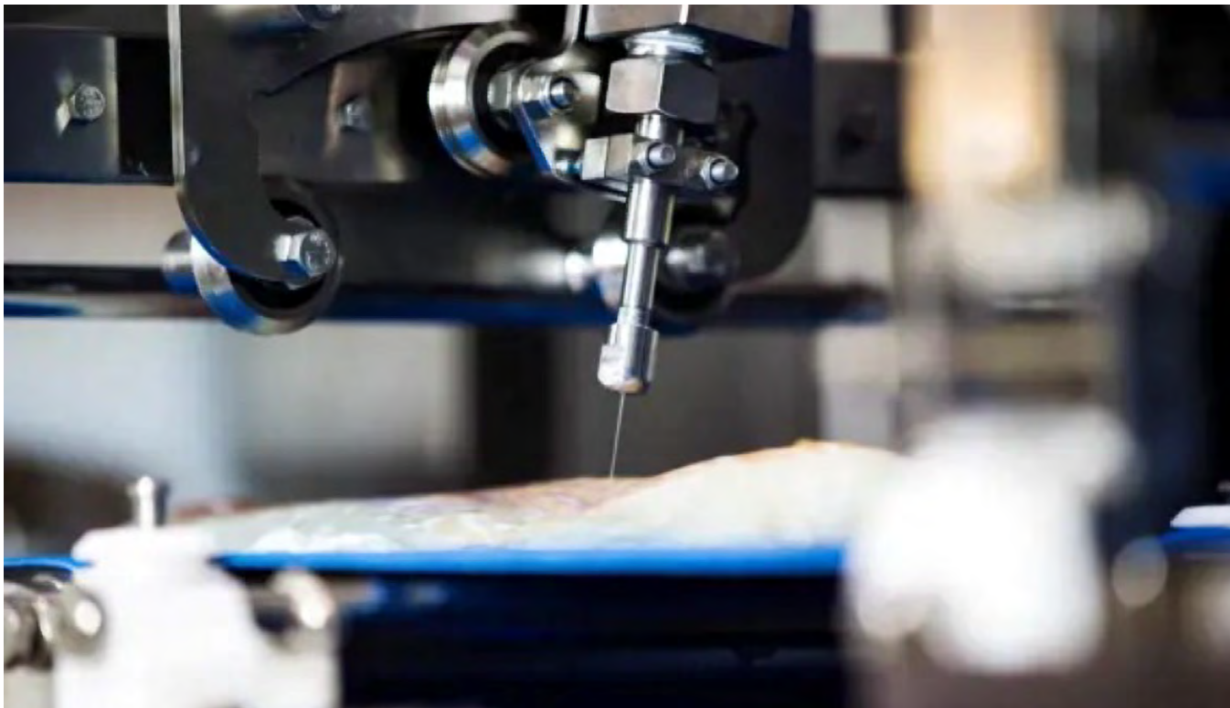
Bilde 1: Bildet viser hvordan vannstrålen kutter i fiskekjøttet. (Foto: Marel)
