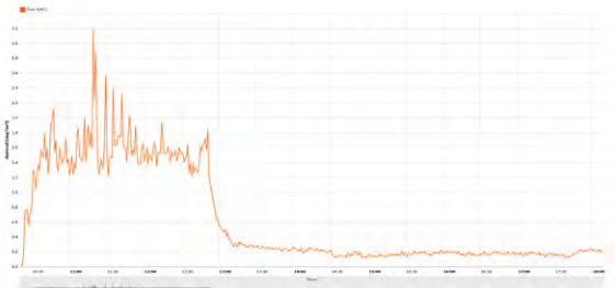
Figur 2: Figuren viser utsnitt av målinger før montering av TurboSwing når maskinen er i drift. Toppverdi er 3,2 mg/m³ og gjennomsnittsverdi er 1,8 mg/m³. Bakgrunnsverdi mens maskinen ikke var i drift (fra kl. 1300) ble målt til om lag 0,2 mg/m³.
