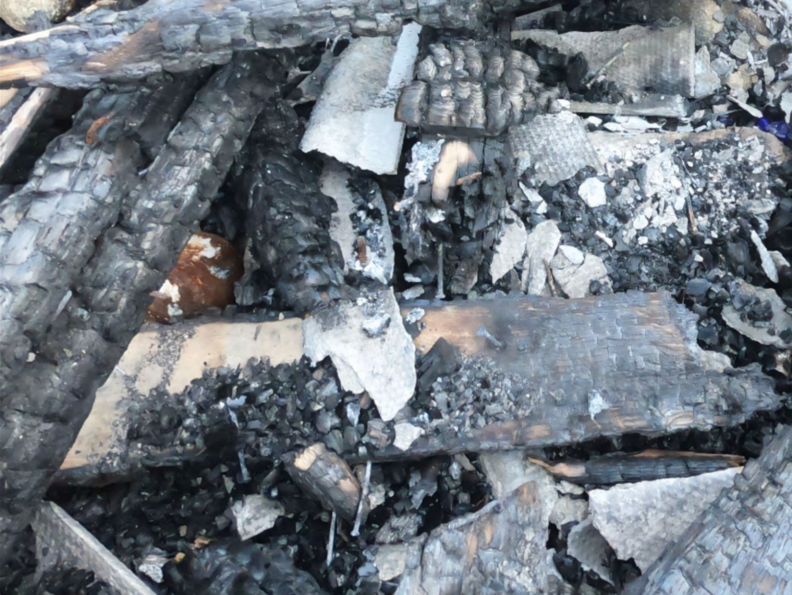
Biter av eternittplater liggende blant aske på en branntomt. Foto: STAMI
